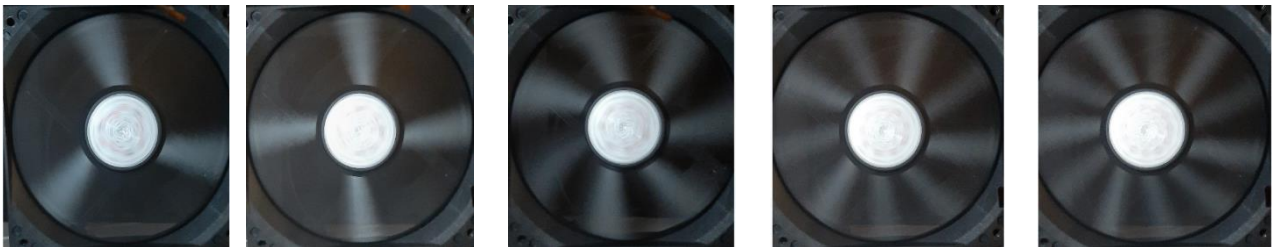
Рис. 2. Лопать вентилятора при освітленні стробоскопом з різними частотами.
