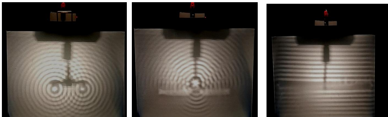
Рис. 4. Інтерференція, дифракція та відбивання механічних хвиль
