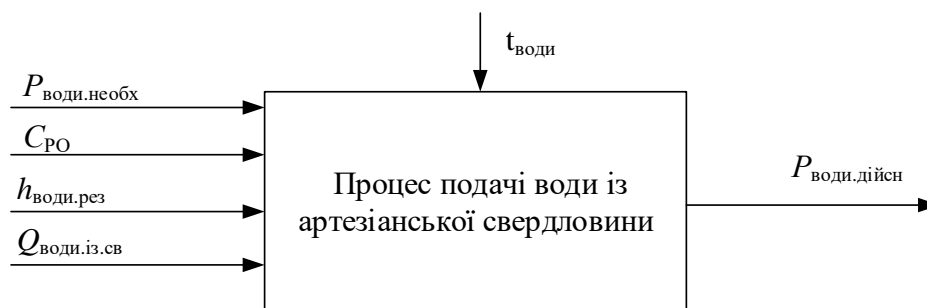
Рис.2. Структурна схема процесу подачі води із свердловини
